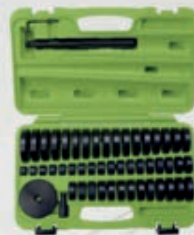
Garnitura specijalnog alata za montažu ležajeva
