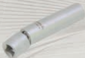
Nasadni zglobni ključ za sveće sa magnetom 14mm Prihvat 3/8" 12-ugaoni Dužina 92mm
