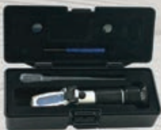
Refraktometer za ispitivanje tečnosti
