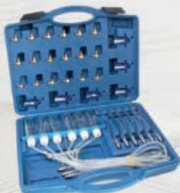
Specijalni alat za ispitivanje preliva dizni u plastičnom koferu.
