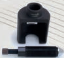
Univerzalni radapciger za montažu / demontažu spone na vozilima
