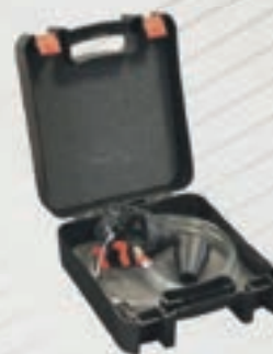
Specijalni alat za vakumiranje i sipanje rashladne tečnosti.
