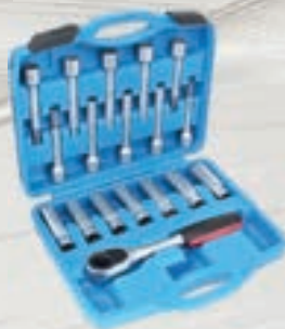
Garnitura specijalnih ključeva za zamenu amortizera 18/1
